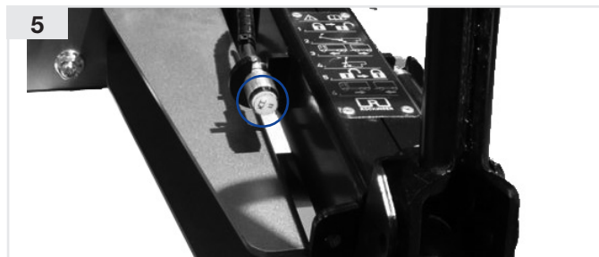
Электрическая дистанционная индикация, индикатор снаружи (RI-BR)
